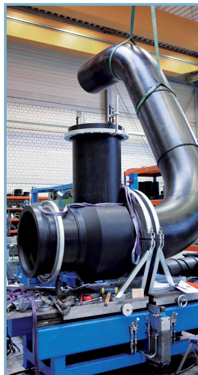
Элементы трубопровода в сборке Fittings
